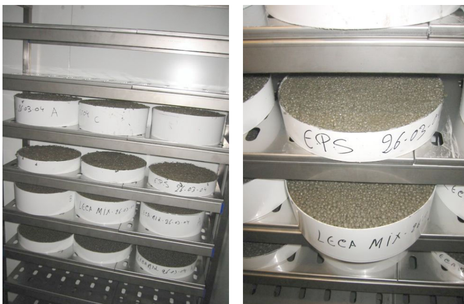
Figura 2 — Provetes de betão leve no interior da câmara climática.
