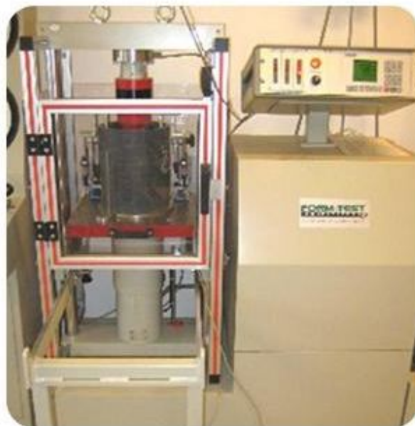
Execução do ensaio de resistência à fluência, conforme prEN 15732, Anexo C
