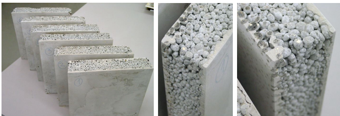
Figura 4 — Provetes de betão leve.
