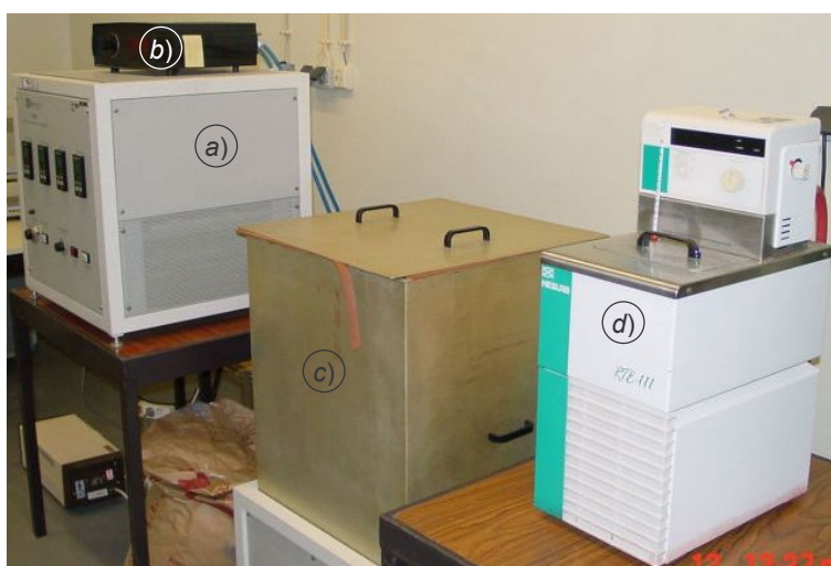
Figura 2 — Equipamento Holometrix ; a) equipamento de controlo de temperaturas; b) equipamento de aquisição de dados; c) recipiente de ensaio dos provetes; d) equipamento de refrigeração.
